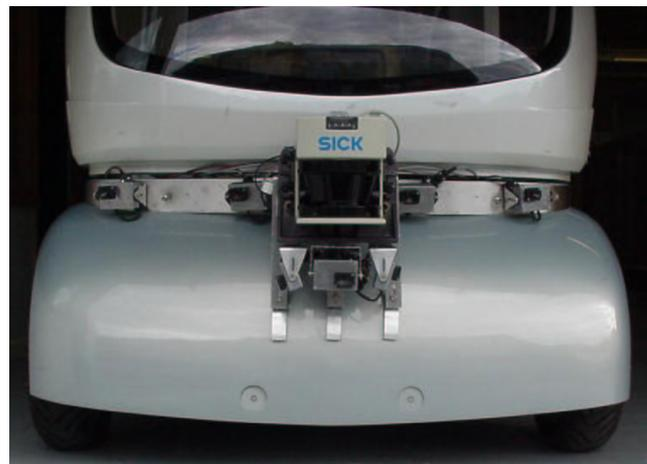
Figure 12: emplacement des capteurs sur le robot
