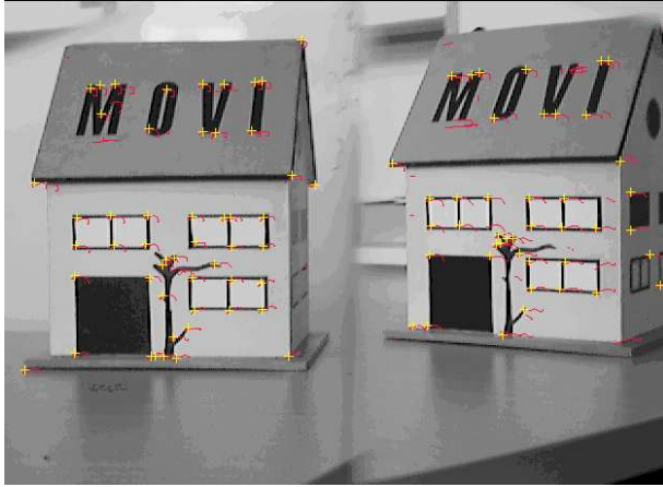
FIG. 13 – Résultat du suivi de points d'intérêt
