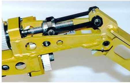
FIG. 5.2 – Système de transmission au niveau du genou
