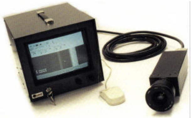
Pour localiser la balise précédemment décrite, on dispose d'une caméra linéaire (linéaire car le capteur CCD est constitué d'une ligne d'éléments photosensibles et non pas d'une matrice comme dans une caméra classique), intelligente (en fait programmable, donc en sortie on récupère directement l'information désirée, et non pas un signal vidéo non traité), et interfaçable via un bus CAN à 1 MBaud (afin de pouvoir communiquer avec le PC qui gère le suivi de trajectoire) :
